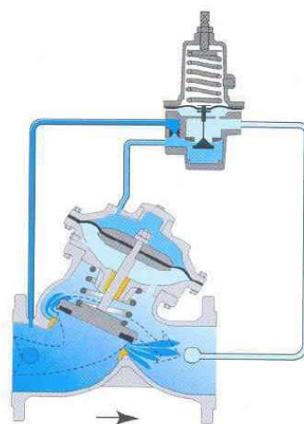
FIGURA 26 – Esquema de válvulas de ação indireta - com piloto.
