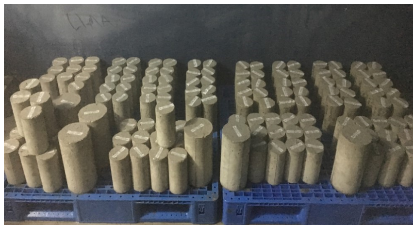
Figura 16 - Cura do concreto em câmara úmida
