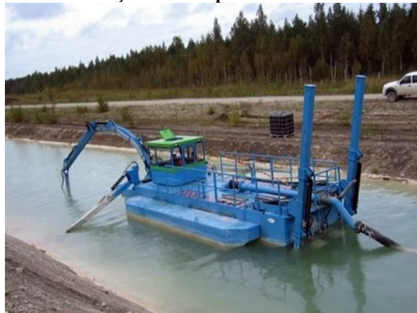
Figura 4 - Modelo alemão de draga hidráulica para extração mineral por cava submersa
