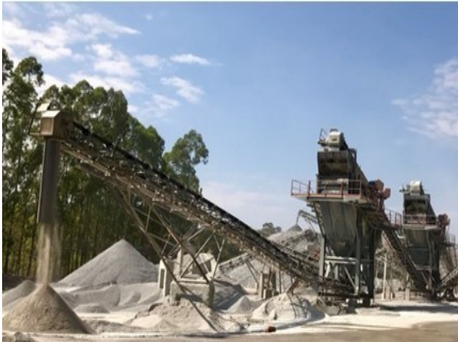
Figura 10 - Processo de cominuição do gnaiss resultando no produto final: areia de britagem
