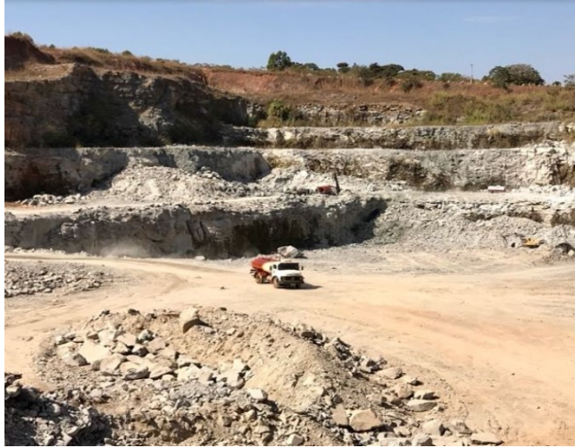
Figura 9 - Lavra em pedreira para extração de gnaiss na pedreira Brita Anápolis
