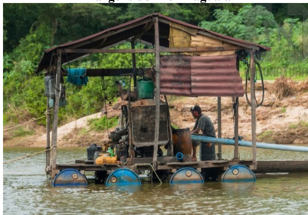
Figura 5 - Modelo de draga improvisada para cava submersa ilegal em pleno funcionamento nas margens do Rio Araguaia
