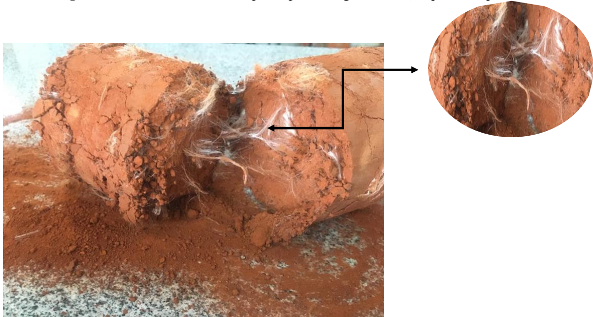
Figura 10. Detalhamento do corpo de prova fragmentado (Arquivo Próprio, 2019).
