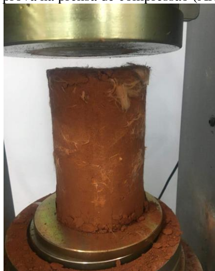
Figura 7. Corpo de prova na prensa de compressão (Arquivo Próprio, 2019).
