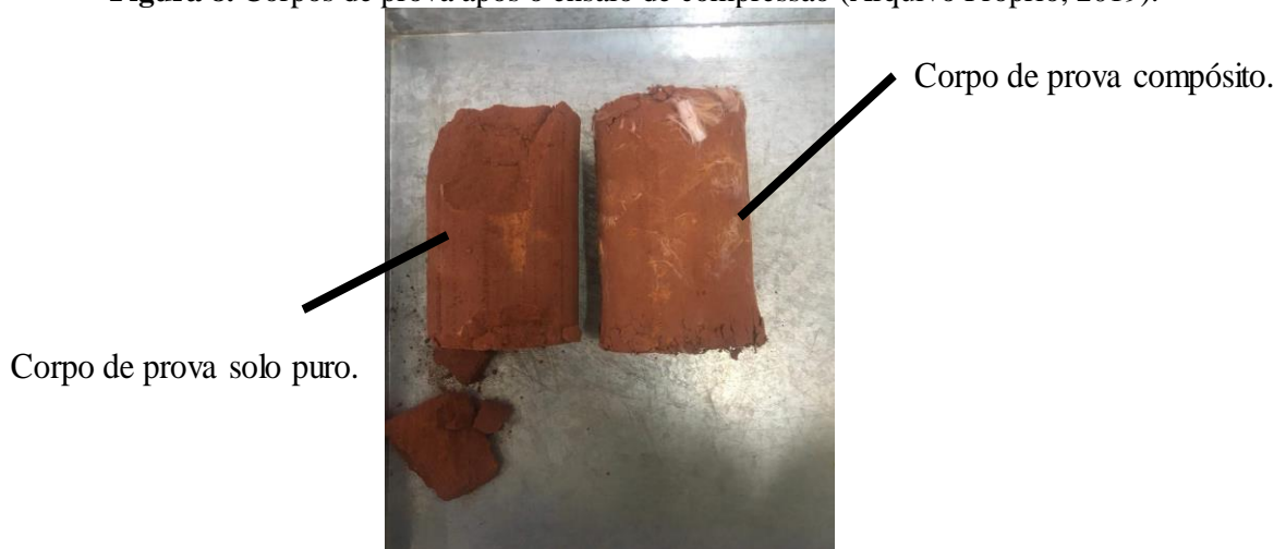
Figura 8. Corpos de prova após o ensaio de compressão (Arquivo Próprio, 2019).
