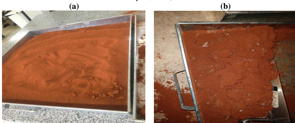
Figura 5. Solo laterítico (a) e solo laterítico com adição de fibra de polipropileno (b) (Arquivo Próprio, 2019).
