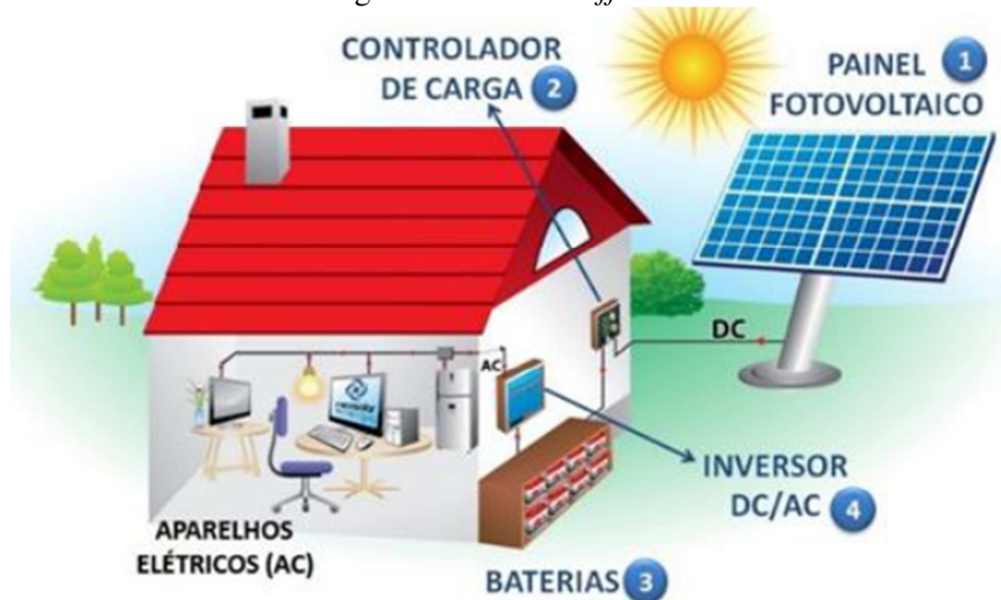
Figura 8: Sistemas Off Grid .
