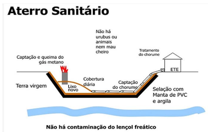
Figura 2 - Modelo de Aterro Sanitário
