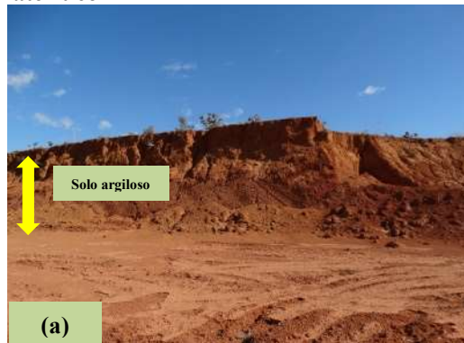
Figura 16 - Latossolo vermelho. (a) Perfil do solo argilo siltoso vermelho. (b) Nível laterítico
