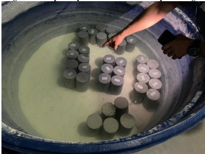
Figura 8 - Corpos de prova submersos em tanque com água
