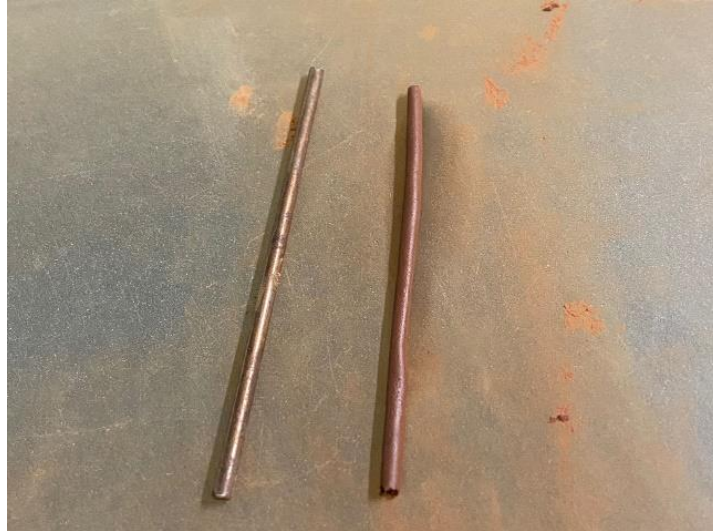
Figura 6 – Amostra de solo cilíndrica de 3 mm de diâmetro
