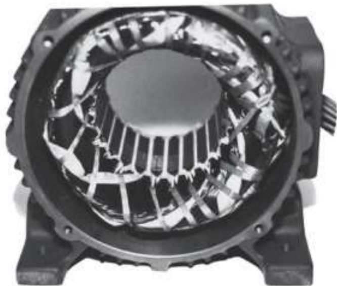
Figura 12 - Estator de um motor de indução
