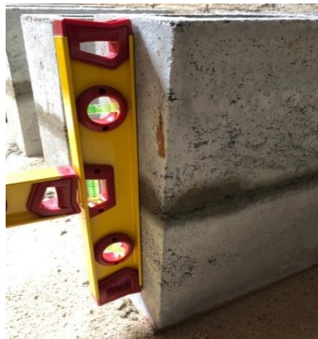
Figura 5 - Nivelamento dos prismas
