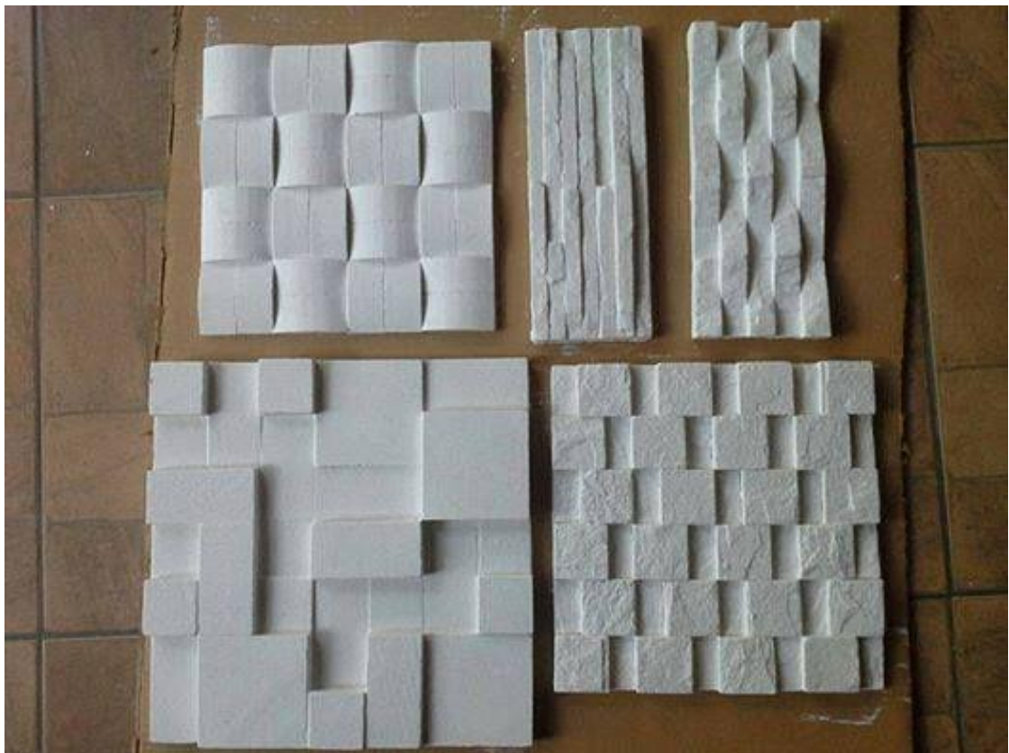
Figura 20 – Revestimento 3D de gesso
