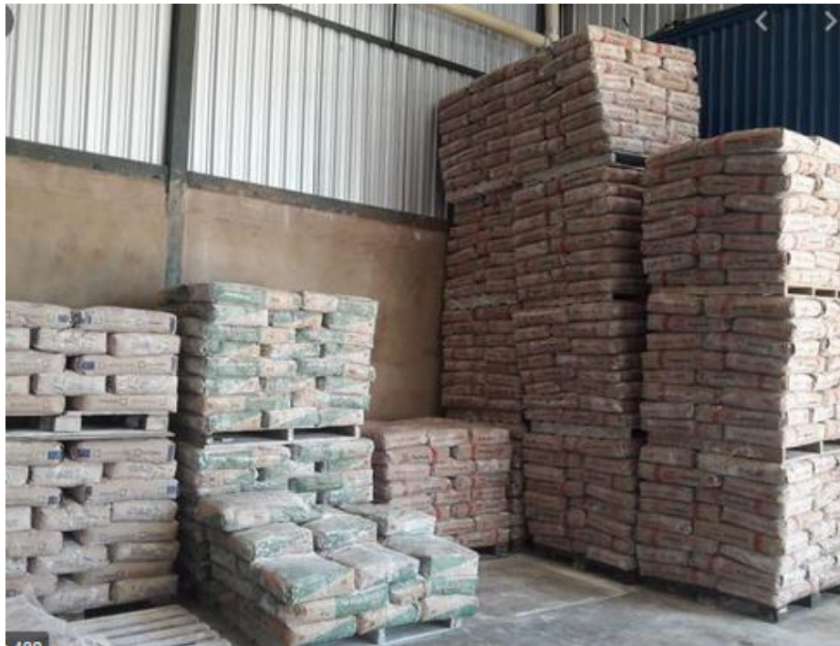
Figura 14 – Armazenagem de gesso.
