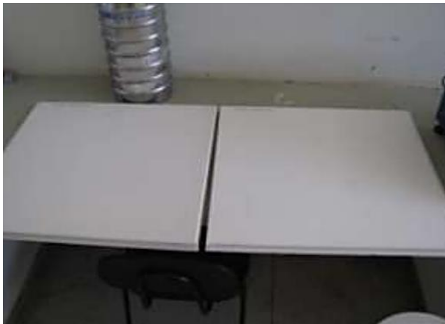
Figura 27 - Aspecto das placas de gesso com 48 horas - gesso reciclado (esquerda) e gesso comercial (direita)
