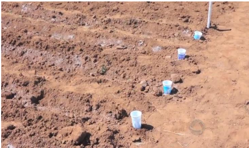
Figura 26 – Solo dividido em aplicação com gesso agrícola tradicional e aplicação com resíduos de gesso
