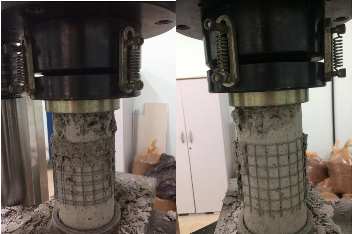
Figura 17 - Teste de resistência com reforço parcial de tela metálica.
