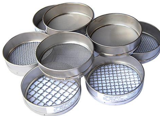
Figura 10 - Peneiras da série normal e intermediária, com tampa e fundo
