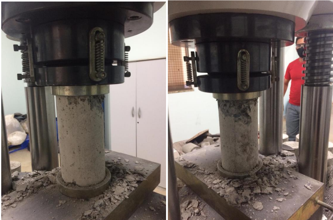
Figura 13 - Rompimento do corpo de prova sem reforço
