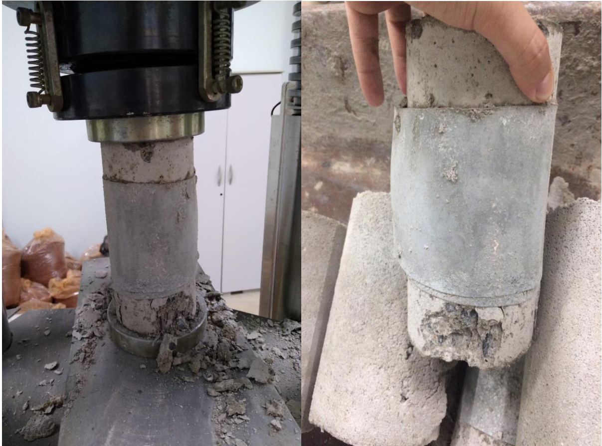
Figura 14 - Teste de resistência com reforço parcial de placa metálica.
