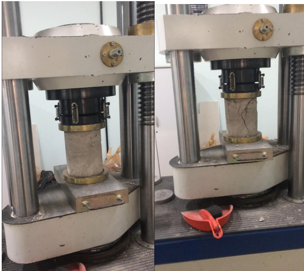
Figura 19 - Sequência do teste de resistência com reforço com aumento de seção
