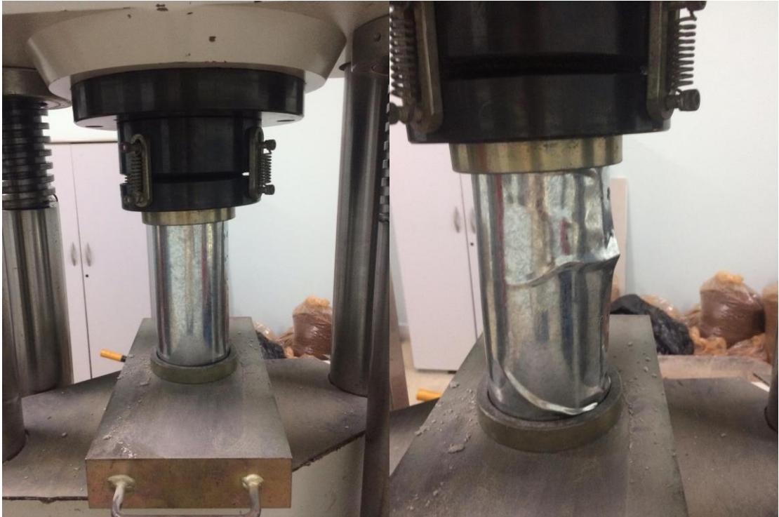
Figura 15 - Sequência do teste de resistência com reforço total de placa metálica
