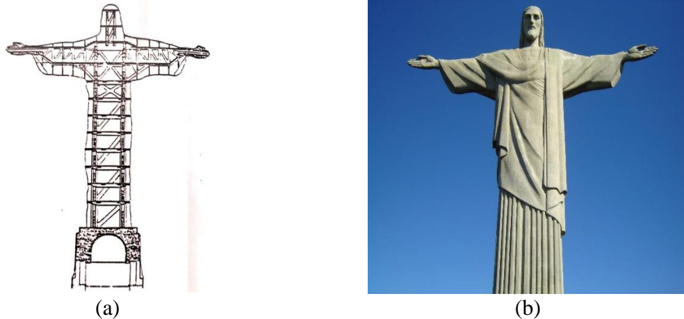
Figura 3 (a) Estrutura de concreto armado do Cristo Redentor; (b) Estátua com 8 m de altura
