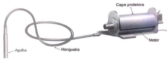
Figura 5 Vibrador de imersão elétrico
