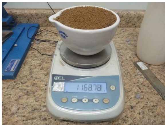
Figura 5 – Recipiente com amostra do agregado miúdo solto.
