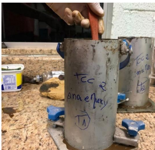
Figura 9 – Tratamento dos cilindros para serem submetidos a moldagem.
