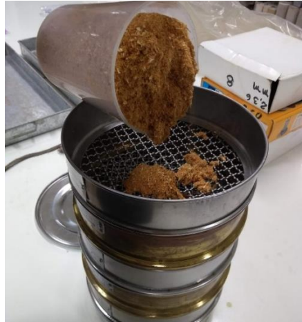
Figura 3 – Processo de peneiramento do material que substituirá em porcentagem a areia.
