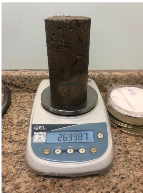
Figura 10 – Pesagem do corpo de provas depois de fazer a desforma.
