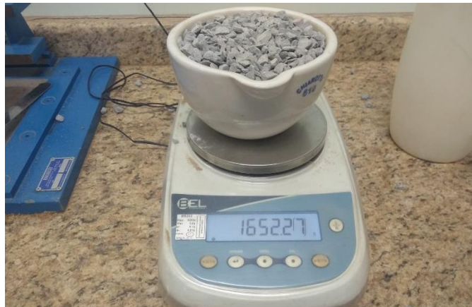
Figura 7 – Recipiente com amostra do agregado gráúdo solto compactado.
