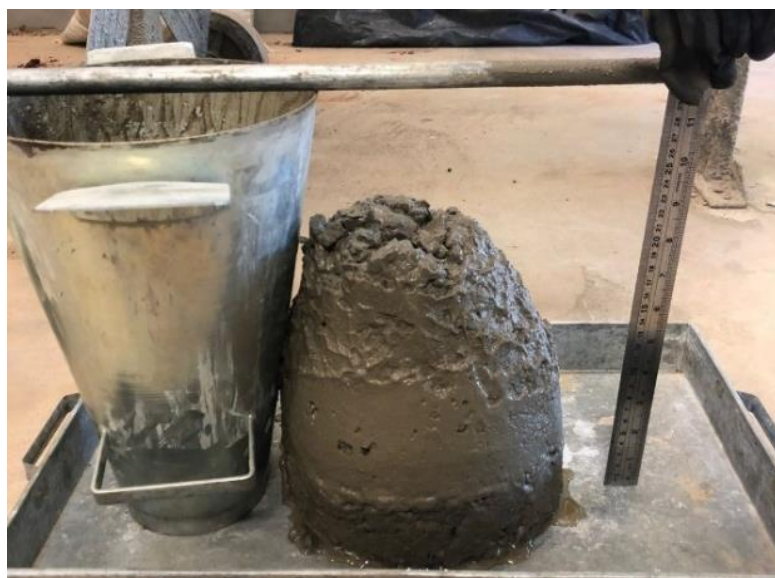
Figura 8 – Abatimento para teste de consistência do concreto.
