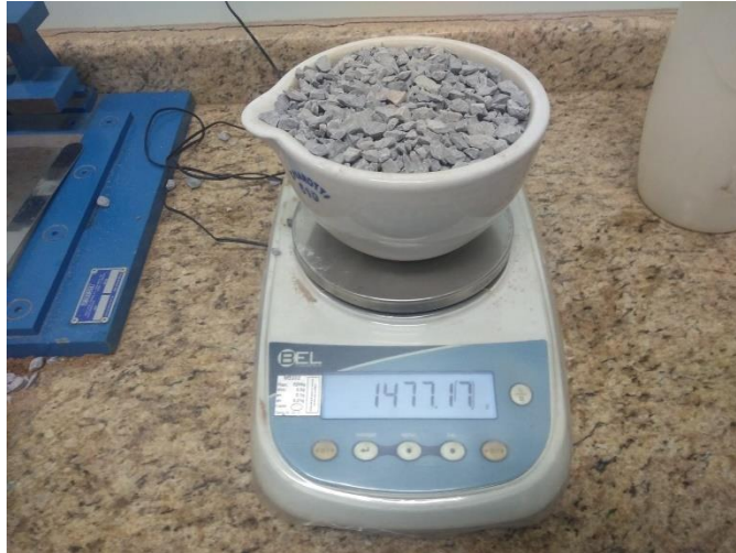
Figura 6 – Recipiente com amostra do agregado graúdo solto.
