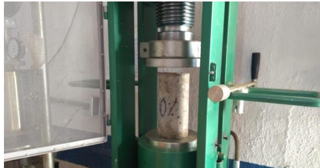
Figura 12 – Corpos de prova sendo rompidos em idade de 14 dias
