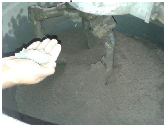
Figura 10 – Determinação empírica da consistência ideal do concreto através do "ponto de pelota".
