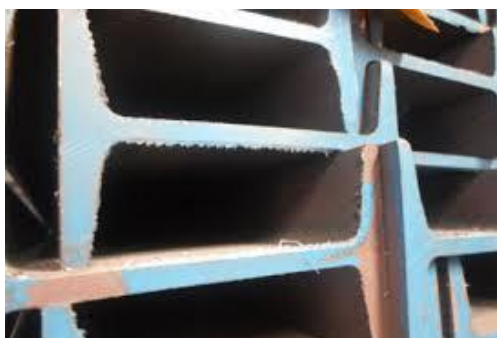
Figura 4 - Perfil metálico I laminado.
