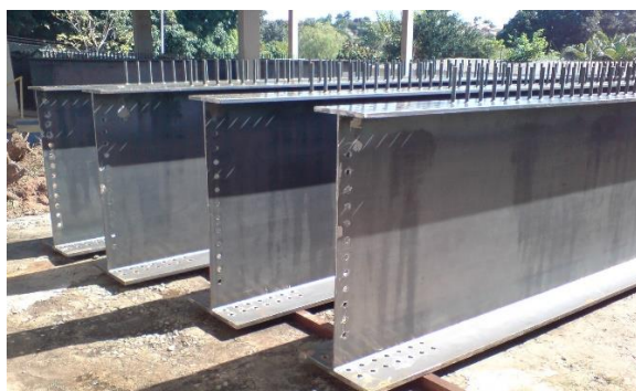
Figura 5 – Viga metálica soldada.
