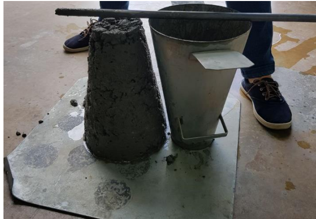
Figura 23 – Abatimento do primeiro traço do concreto referencial
