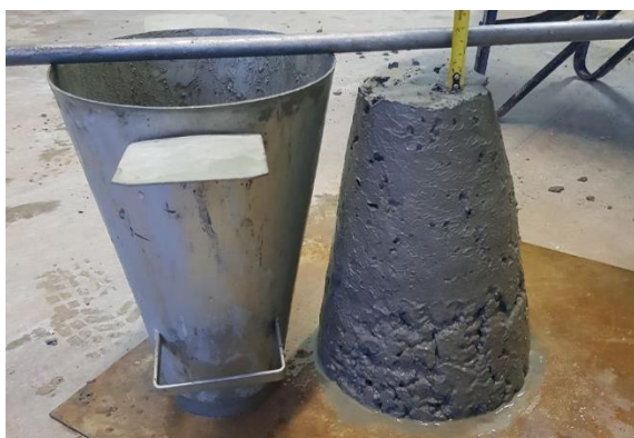
Figura 33 – Abatimento do concreto com substituição de 15%
