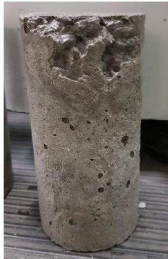
Figura 34 – Concreto com adição de 5% para o rompimento aos 28 dias
