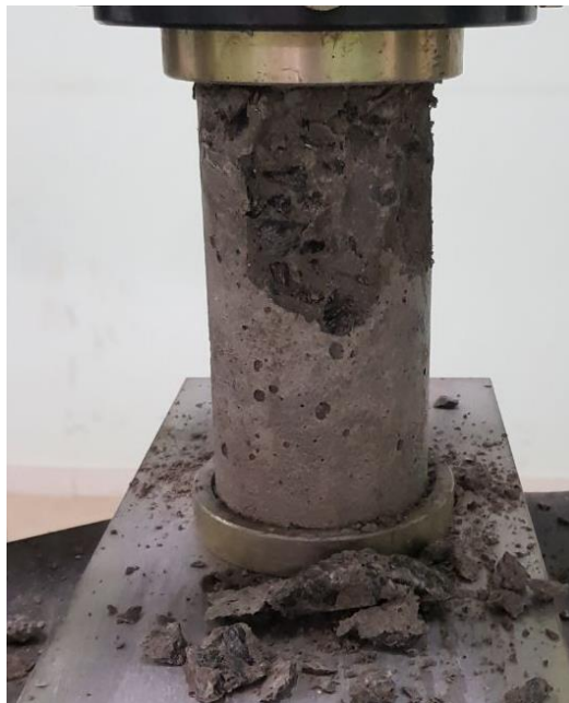
Figura 35 – Corpo de prova rompido aos 28 dias – Traço 10 % de adição
