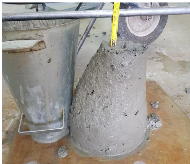
Figura 31 – Abatimento do concreto com substituição de 5%
