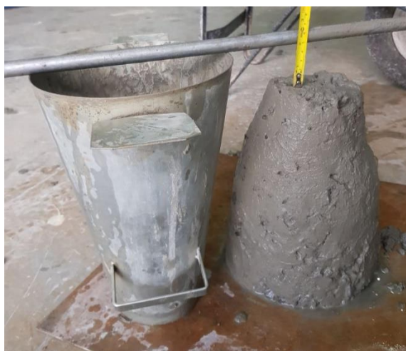
Figura 32 – Abatimento do concreto com substituição de 10%
