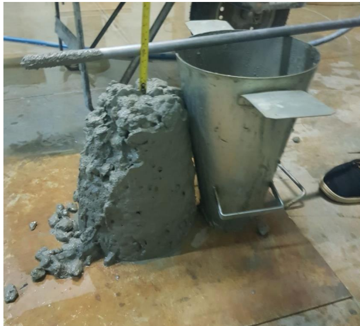
Figura 27 – Abatimento do concreto referencial
