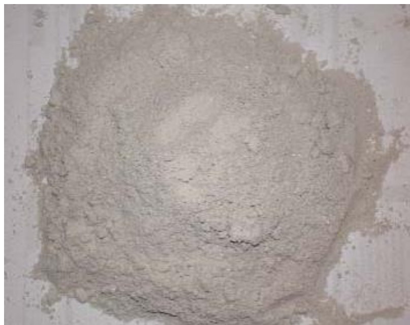
Figura 16 – Resíduo de corte de granito para aplicação no concreto
