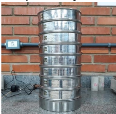
Figura 2 – Peneiras para execução do ensaio granulométrico de agregados miúdos
